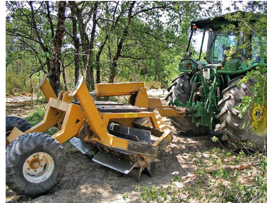
Le rouleau landais reste l'outil le plus utilisé pour entretenir les boisements de Pin maritime.
