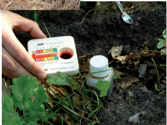
Matériel pour examen du sol : mesure de pH.
