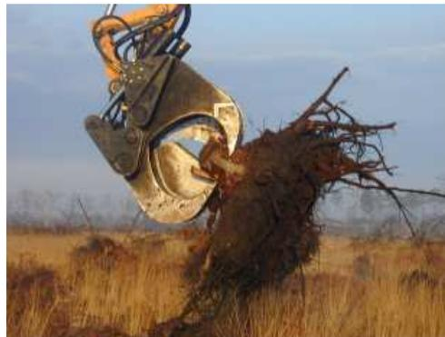
*Figure 5 : Croque souche utilisé aussi bien pour le déchiquetage des souches que pour leur mise en cordons*
